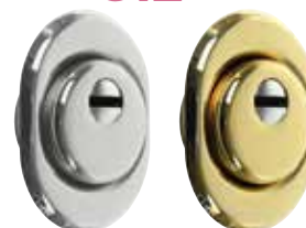
PROTEZIONE CORAZZATA 'BLINDUS' in acciaio carbonitrurato. Interasse 38 mm Per tutti i tipi di serrature a cilindro europeo. Altezze regolabili con molla Cod. 5598 cromo satinato 6÷11 mm Cod. 55943 cromo satinato 14÷25 mm Cod. 55966 oro 6÷11 mm Cod. 55941 oro 14÷25 mm
